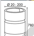
**4 PGE8015** - paracolpi cavo rigato giallo/nero, senza biadesivo. Protegge colonne tonde, pali e corrimano, utilizzato anche come salva colonne in parcheggi e garage. Ø minimo 20 mm, Ø max 200 mm. Altezza 780 mm, spessore 20 mm, peso kg 1,2
